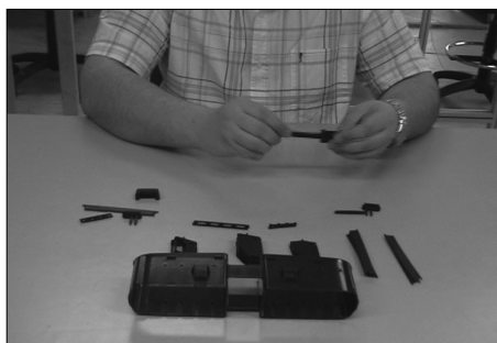
Obr. 4: Print screen videozáznamu ručnej montáže vetracej mriežky
